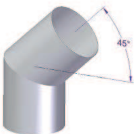
Figura 1 - Inclinação correta para as curvas
